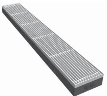
Der elektrische Unterflurkonvektor wird als einbaufertige Einheit direkt auf dem Rohfußboden montiert. Nach dem Verlegen des Bodens ist nur mehr der Rost zu sehen, der in verschiedenen Farben und Ausführungen geliefert werden kann. Der Unterflurkonvektor bietet hohen Komfort, indem er Schutz gegen die - von großflächigen Fensterscheiben durchgelassene - Kältestrahlung bietet. Die größeren Modelle besitzen ausreichende Leistung um als Hauptheizung zu fungieren.
